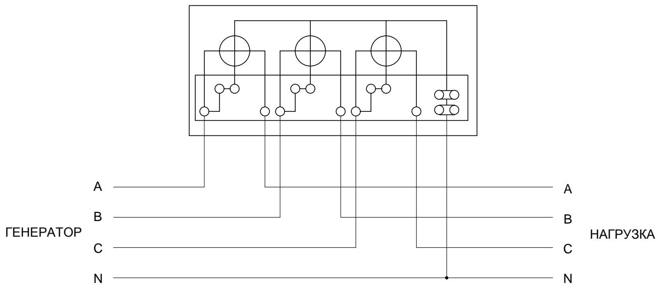
Пример схемы подключения трехфазного электросчетчика
