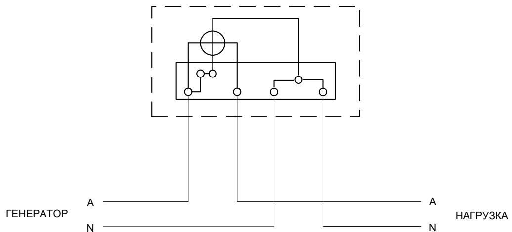
Пример схемы подключения трехфазного электросчетчика
