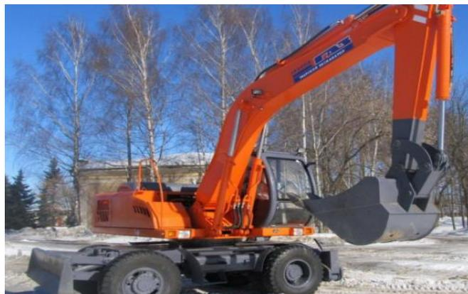
ЕК-12-10 отлично подходит для выполнения работ в ограниченных пространствах благодаря возможности уменьшения поворотной платформы. Благодаря уникальной геометрии стрелы экскаватор позволяет создавать глубокие и узкие колодцы и котлованы. Подобные работы могут выполнять немногие модели. Специальная конструкция техники позволяет транспортировать ее без ограничений даже по дорогам и трассам общего назначения. Управлять ЕК-12-10 интуитивно понятно и просто.
